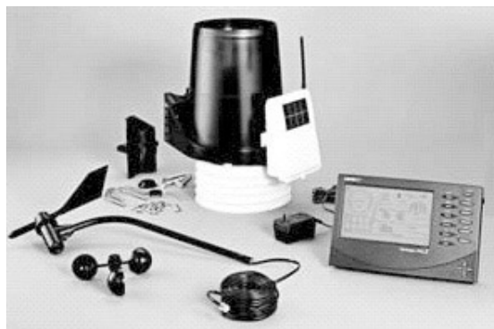
写真4-3 市販の気象センサをAPRSと接続することができる 〔写真提供=Davis Instruments Corp. ( http://www.davisnet.com/ )〕
