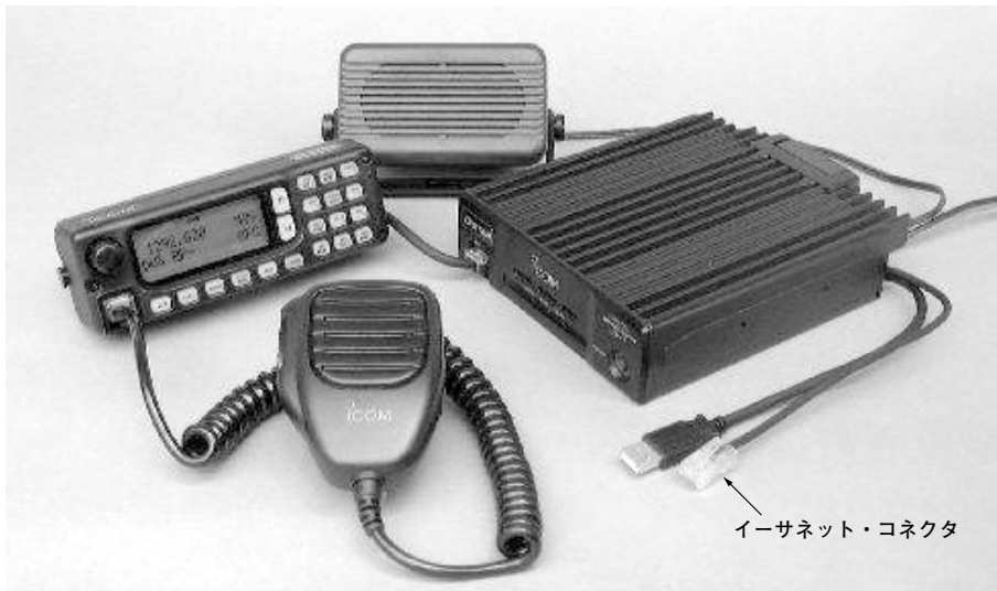
写真1-1 1200MHzD-STARリグ(アイコムID-1)にはネットワーク用にネットワーク・コネクタ(イーサネット・コネクタ)が付いている(写真右下)。USBコネクタはリグをパソコンで制御するときに使う。またUSBコネクタは低速データ通信(シリアル通信)にも使う
