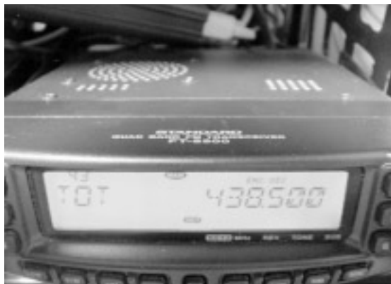
写真8-3 無線機についている機能を活用して、連続送信などのトラブルを回避できる設定にしておこう
