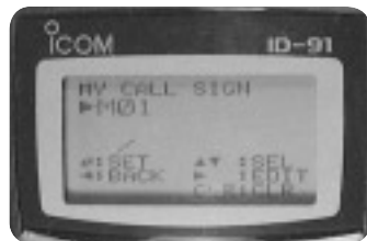
写真1-21 自局コールサインは6個までメモリーできる 例にはM01とあるので1ch目に記憶しようとしている。→キーで入力すすむ
