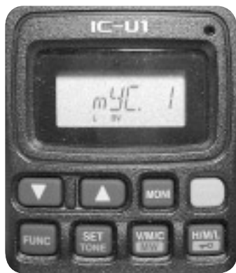
写真1-11 IC-U1/V1で自局コールサイン (例としてJA3VAP/1)を設定する まずオプションセット・モード (SET TONE ホット長押し) で自局コールサイン設定を呼び出す
