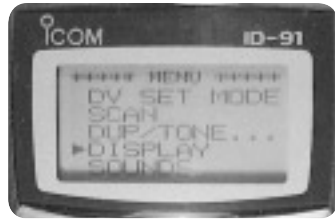
写真1-18 自局コールサインはMENUキーを短く押すとMENUが出る このキーは長押しすると操作ロックとなるので注意。操作ロックを解除するには、再び長押しする
