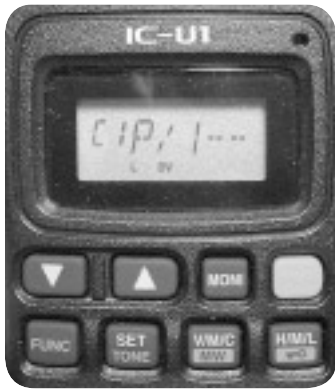
写真1-14 誤った設定例(スクロールさせた右端) 移動先表記などの「/1」はコールサインの後に続けないこと
