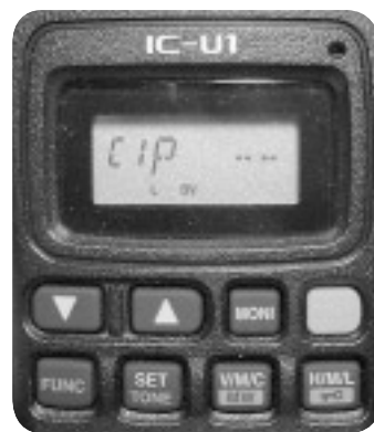
写真1-13 ディスプレイの幅が不足しているが▲キーで文字がスクロールする
