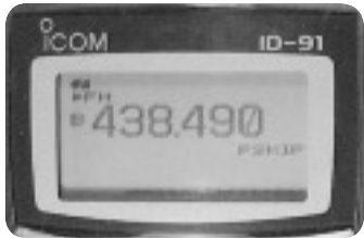
写真1-17 ID-91で自局コールサイン(例として JA3VAP/1)を設定する 設定に先立ち、MAINバンドを「Bバンド」にする必要がある。DVモードはBバンドのみ動作するため必要な操作である。なおここで表現する「Aバンド」「Bバンド」とは周波数帯を意味するのではなく、二つあるVFO AとVFO Bの切り替えと考えたほうが理解しやすい。Bバンドに設定するにはMAINキーを押し周波数表示の左端の表示を確認する
