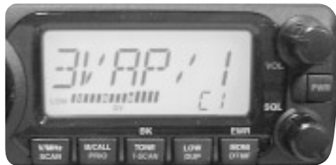
写真1-10 誤った設定例 (ディスプレイの幅が不足しているため右へスクロールさせている) 移動先表記などの「/1」はコールサインの後に続けないこと
