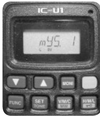
写真1-15 IC-U1/V1の場合は移動先表記などを設定するため専用の設定(myS)があるのでこれ呼び出す 取扱説明書に「自局のコールサイン(2nd)」と記載されている
