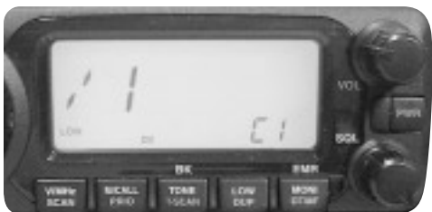
写真1-9 次に出た項目には移動先表記などを入れる これは省略可。設定が完了したらディスプレイ下にあるどれかのキーを押すと戻る
