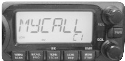
写真1-7 次に自局コールサイン設定を呼び出す (SET LOCK キー押し)
