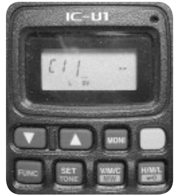
写真1-16 mySを呼び出して正しく設定した例 これは省略可。設定が完了したらSET TONEキーを短く押すと戻る
