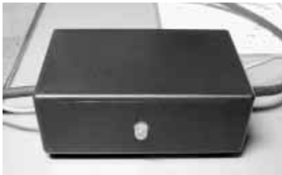
写真1-5 トランシーバからスケルチ開放時の信号、通称COSでEchoLink ネットへの送が行える自作インターフェース (Carrier Operating Squelch) DATA端子搭載のトランシーバではCOSを使うとネットに対して切れのよい伝送ができる
