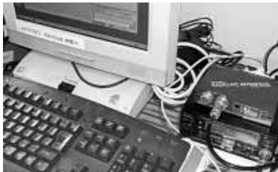
写真1-6 EchoLinkのノードを稼働している局の例 (このCPUはCeleron 266MHz) ノート・パソコンならコンパクトに構成できる。能力の低いパソコン (Pentium 200 MHz クラスでも稼働している) を EchoLink 専用として使えるので常時運用にはリサイクル的なパソコンを使っている局も多い
