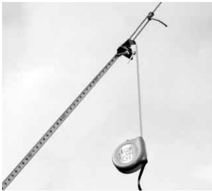
写真2-5-4 フックとクランプを使って巻き尺スケールを固定する
