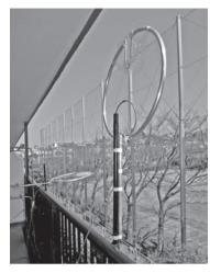
ベランダの手すり 近くに、垂直と水 平に設置したMLA (Field\_ant 製 MK-3)
