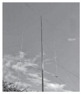
GW4MBNによる20m用垂直Moxonアンテナ Moxonアンテナ・プロジェクトのWebサイト (http://www.moxonantennaproject.com/) より
