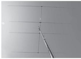
クリエート・デザイン 4エレメント18MHz YAGIアンテナ
