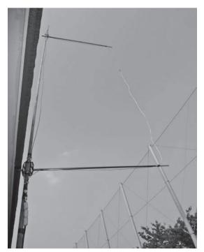
写真7-1 1エレメントのタテ長クワッド・アンテナ
