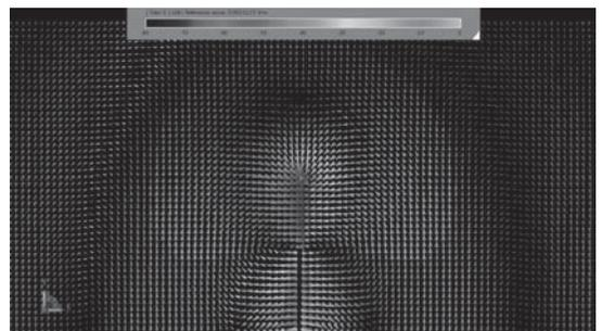
図1-3 ラジオ放送用アンテナの電磁界シミュレーション結果で、電界ベクトルを表している（位相角:90°）
