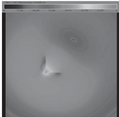
(b) 平板の手前から2cm入った断面の電界強度分布(位相角:0°). 右上に電気力線のループが発生している
