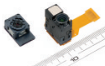
図26 オート・フォーカス付きカメラ・モジュール 4.7cm 3 の体積の中にオート・フォーカスに加えて2倍の光学ズームも搭載。
