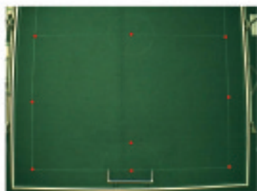
写真6 座標変換の係数を求めるために計測する九つの点 赤丸で示した点のカメラ画像における位置を求める.
