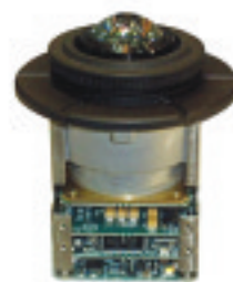
図28 全方位カメラ・モジュール(カメレオン・アイ) 光学歪みはデジタル処理で補正する。
