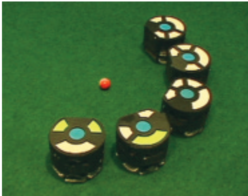
写真8 マーカの例 中央に敵味方を示す直径50mmの黄色もしくは青色のマーカがある。
