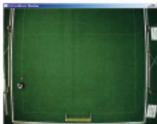
写真7 ロボットがフィールド端にいるときの画像 ボールとマシンをライン上に並べているのに、画像上からは、ライン上に並んでいるようには見えない.
