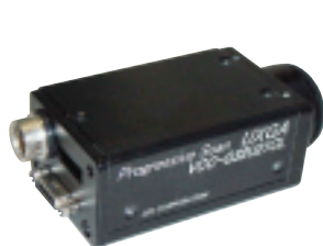
図23 高速カメラ(シングルタップCCD) 普通のCCDを70画素/秒以上で走査する技術を実用化した高速化カメラの例。
