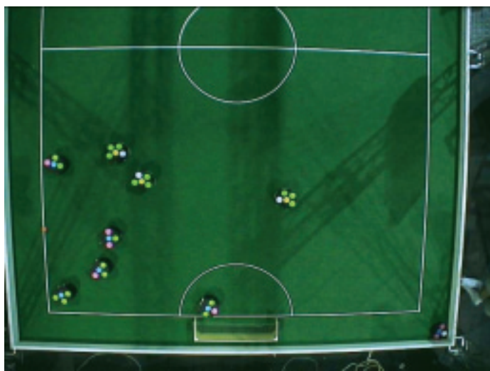
写真5 カメラから得られたフィールドの画像 「本番」では、画像データの位置から実際のフィールド上の位置に変換が必要になる.
