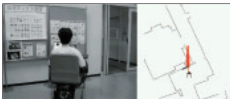
図17 注視推定機能をもつ自動走行モードのようす もう一つの走行モード「注視推定機をもつ自動走行モード」での実験のようす。
