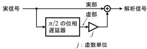
図 11-1 実信号  $f[m]=A\exp[j\omega_0 n]$  から解析信号を生成する方法
