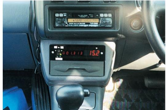
写真D 距離・時間・時速が測れるマルチ・モード・メータ(第7・2章)
