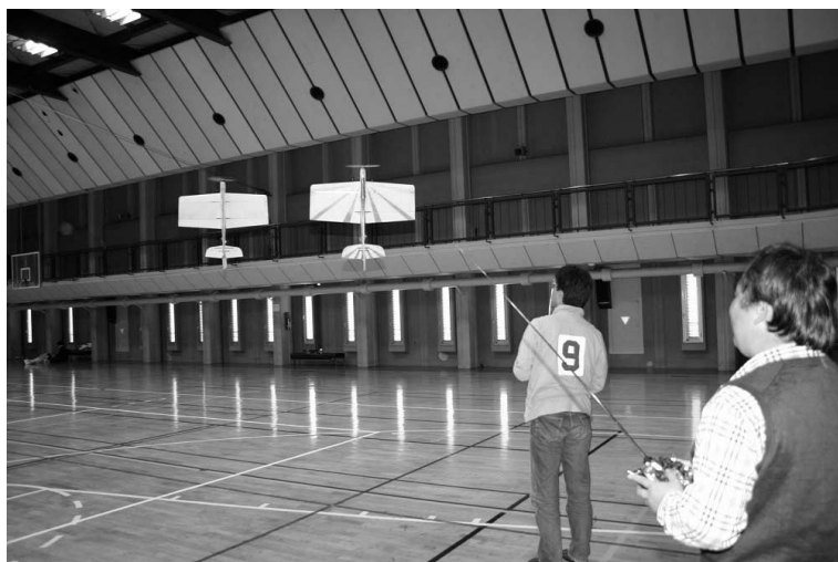
写真6-1 トルク・ロール 飛行機を空中に浮かんだ状態にコントロールしている(機体: keiFUN, 操作: 左奥は広瀬氏, 右手前は吉岡氏)
