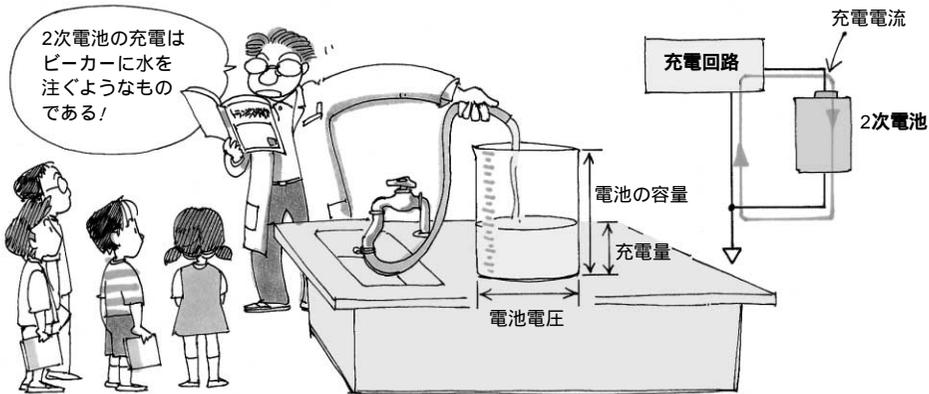
図2-1-1 2次電池への充電をピーカー・モデルで考える
