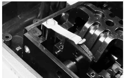
写真2.5 はずしたスロットル・スプリングの取り付け
