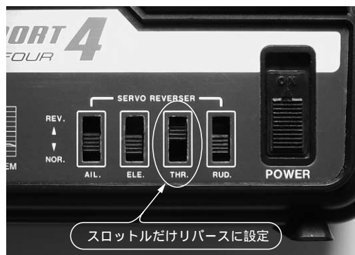
写真2.7 サーボの動作方向を切り替えるスイッチ 4チャンネルすべてに、動作方向を切り替えることができるスイッチがついている。写真ではTHR.がREV.側に切り替えてあるが、多くの市販のスピード・コントローラがREV.設定で使用するようになっていて、本書で製作する受信機もTHR.をREV.に設定しているため。
