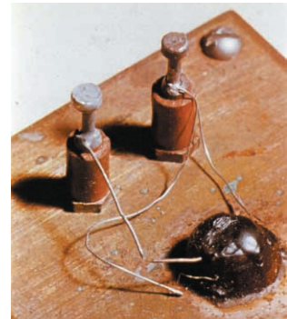
写真2 (3)▶ 最初の接合型トランジスタ
