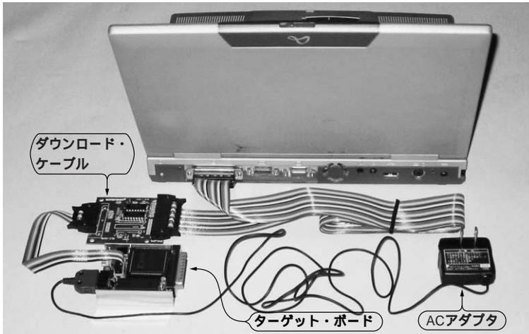
写真5.6 CPLDを基板に実装した状態で、ダウンロード・ケーブルを使ってパソコンと接続した様子
