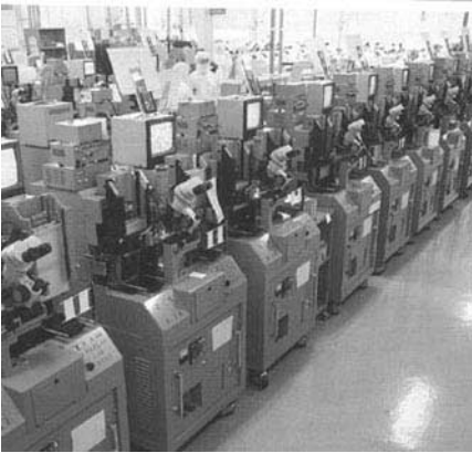
(a) 自動ワイヤボンディング装置 (セイコーエプソン提供)
