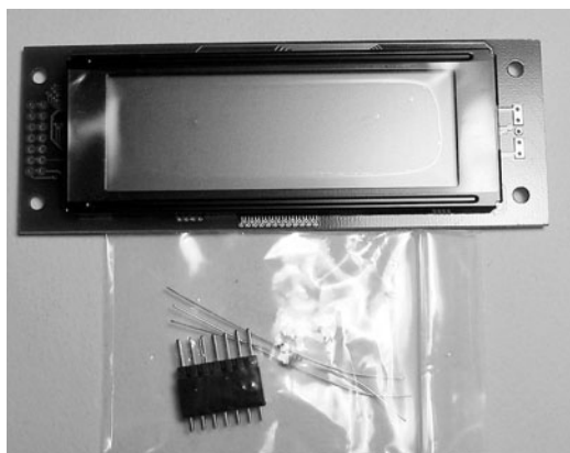
写真4-2 20文字4行LCDモジュール (SC2004CS * B) SC1602Bとは電源ピン配置が違うので注意。
