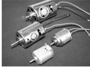
写真3.2 模型用直流モータ
