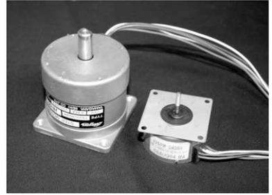
写真3.3 ステッピング・モータ
