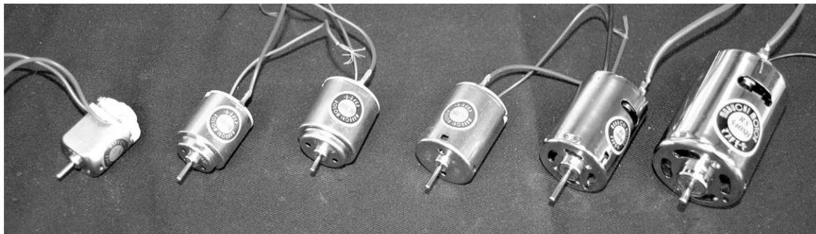
写真6.1 模型用直流モータの外観(マブチモーター製)
