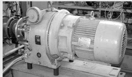
写真6.A 産業用交流モータ(出力7.5kW)
