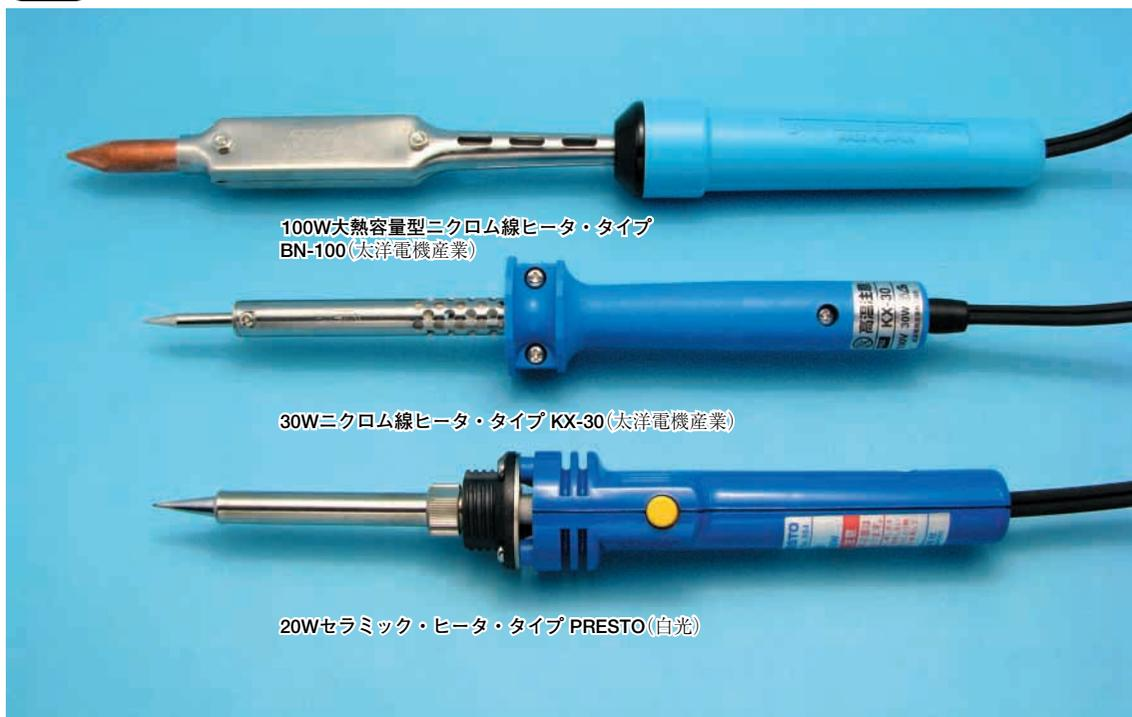
はんだごては、基板、部品の端子、リード線などの母材と糸はんだを、 $240\sim 250^{\circ}\text{C}$ の温度まで上げる役割をもっています。母材やはんだの温度上昇は、こてのワット数やこて先の形状、また母材の大きさや形状によって違ってきます。電子工作用には熱容量(電力)の小さいはんだごてを選びます。
