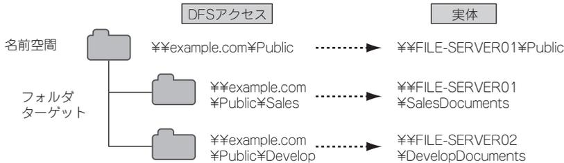
図6.73 「FILE-SERVER02の共有フォルダの設定」で行う操作 — 論理構成
