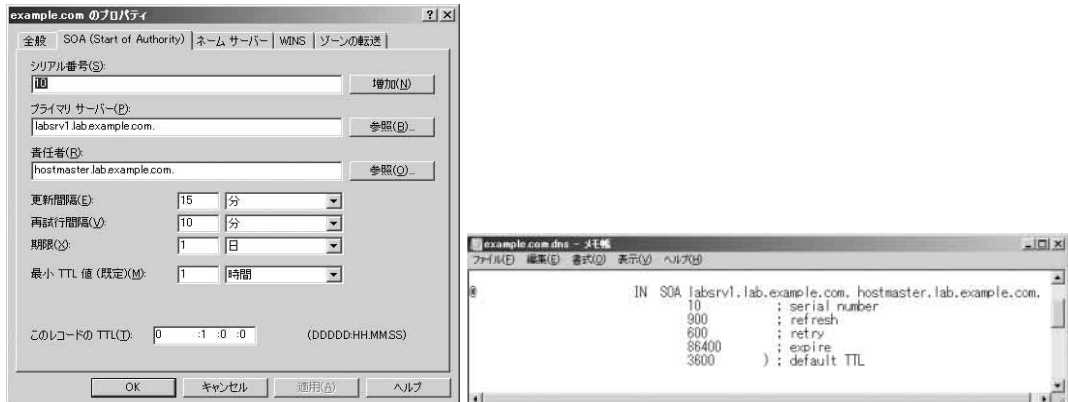
図2.19 「SOA (Start of Authority)」タブ 図2.20 ゾーンファイル中のSOAレコード
