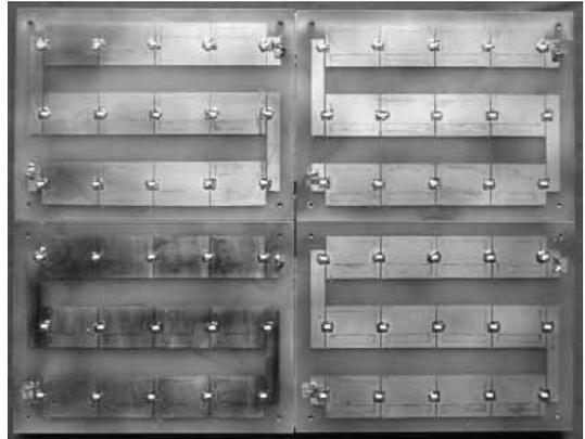
〈写真14-5〉4枚のLED基板をアルミ板上に固定する
