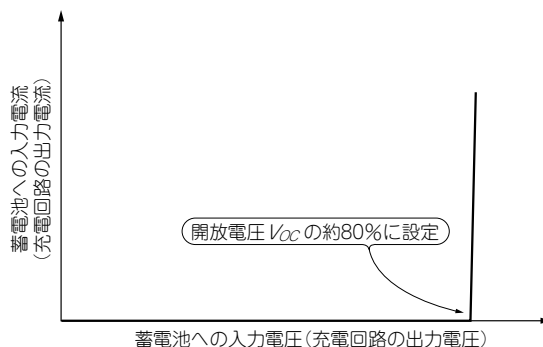
図8-1 太陽電池から最大出力を引き出す充電回路の出力特性
