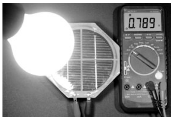
写真2-2 60 Wの電球を30 cmほど離して太陽電池に照射
