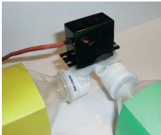
(f) 緑ボトルのキャップとRCサーボ [A] に接着したキャップの接着
