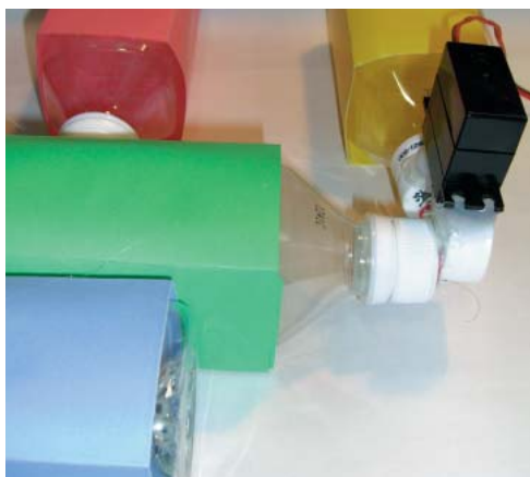
(g) 青ボトルを緑ボトルの背面に接着し、赤ボトルのキャップを緑ボトルの側面に接着
