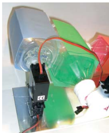
(j) RCサーボ [B] の底部をアルミ板などの硬く広いものに接着
