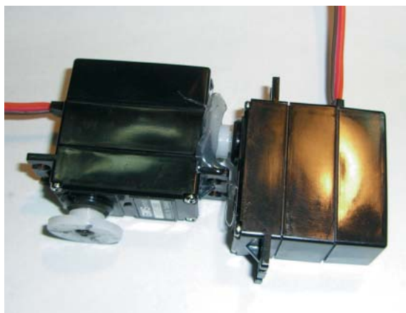
(h) このようにRCサーボ [B] の軸をもう 1 個のRCサーボ [C] の側面に接着
