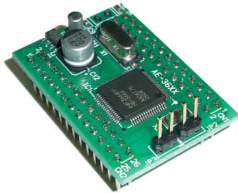
ロボット制御の中心をになうマイコンH8Tiny
