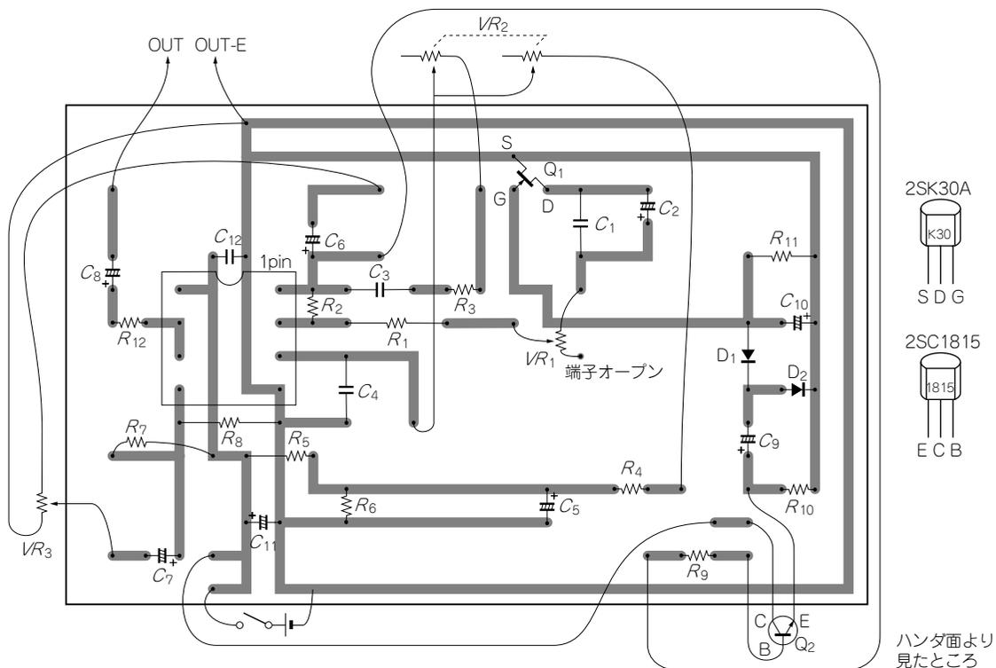
図4-1-7 製作した発振回路の実体配線図
