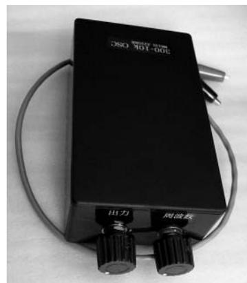
写真4-1-13 ケースに収めて完成させた発振器外観
