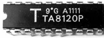
写真3-1-2 AMステレオ用という特定の機能しか持たない IC TA8120P
