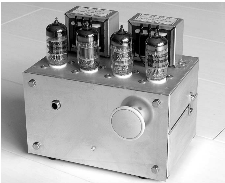
写真3.1 完成した12AU7プッシュプル・ステレオ・アンプ
