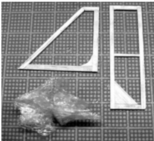
(a) 接着剤を塗布した骨組みとシワを付けるためにまるめたフィルム
