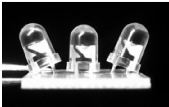
写真1-14 赤外発光ダイオードの取り付け
