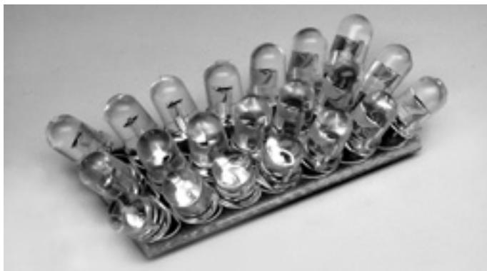
写真1-15 完成したLED基板
