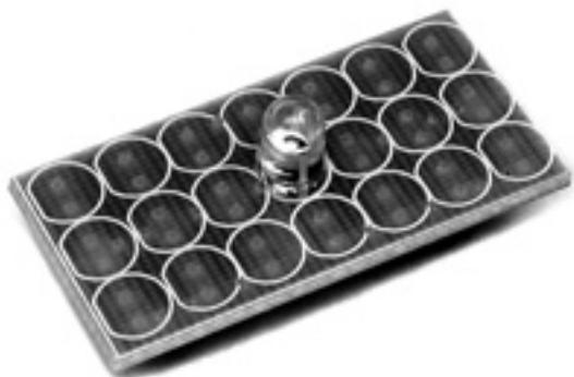
写真1-13 中央に赤外発光ダイオードを取り付ける
