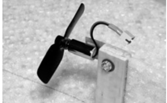
写真4-28 モータ・ユニットの取り付け モータ・ユニット取り付け用の穴に、タップでネジを切っておけば、ワッシャとナットは不要で、その分軽くなる。
