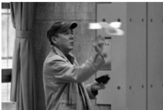
(a) 軽くて低速のインドア・プレーンは気流の影響を受けやすいので、気流の安定した体育館は飛行テストに向いている
