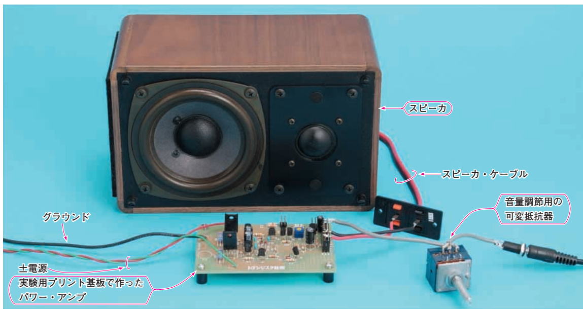
写真1 第6章で作るトランジスタ・アンプでスピーカを鳴らしているところ
