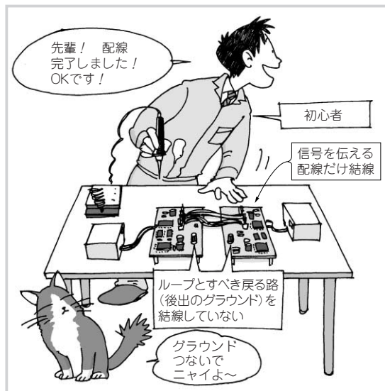
図1-2 初心者が二つの大きな回路ブロックの間をつなごうとしている
