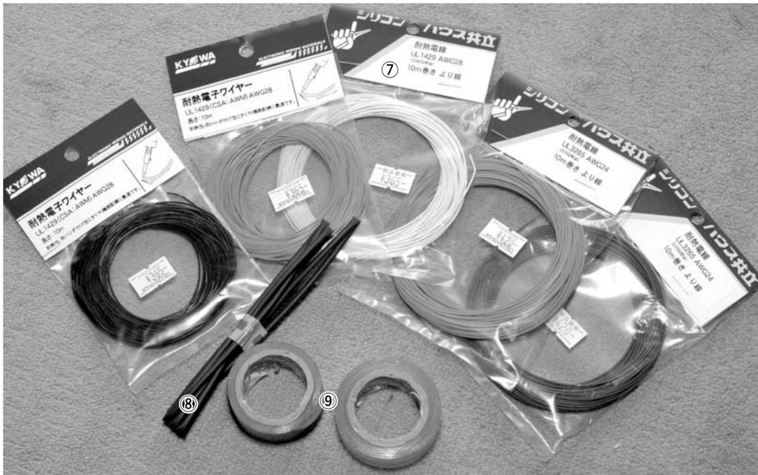
写真1-1 上：必要な工具。① はんだゴテ、② コテ台、③ マイクロ・ニップ、④ デジタル・テスタ、⑤ 精密ドライバ(プラス)、⑥ はんだ。下：色と太さの違う⑦ 電線と⑧ 熱収縮チューブ、⑨ ビニール・テープ
