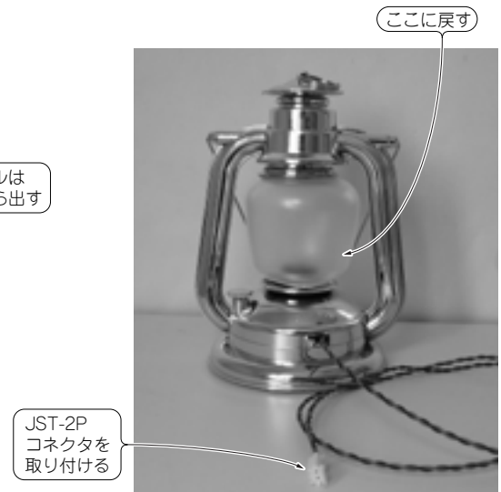
写真4-10 LED内蔵ランプ型ライトの完成
