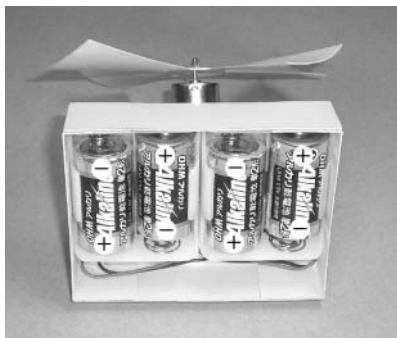
写真3-3 底の部分に単2型アルカリ電池を4本入れる
