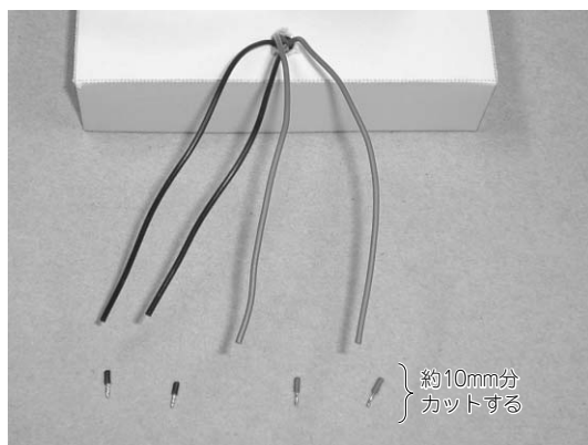
写真8-2 電池ホルダのリード線を約10mmカットする
