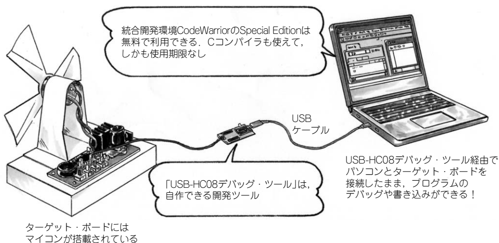
図9-1 KMC908QY4A ユーザ・モード・モニタ入りマイコンの開発環境
