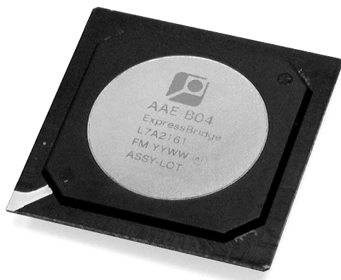
写真 7-1 PCI Express-ローカル・バス・ブリッジ LSI の例 アパールデータ製「AAE-B04」。
