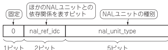
図2 H.264ストリーム・データを構成する単位NAL unitの先頭1バイトのヘッダ…NALユニット・ヘッダ
