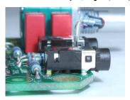
ミニジャックを基板に挿入します。基板から浮かないように充分に下まで差し込んで下さい。横から見た際に隙間がなくなるはずです。
