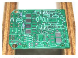
基板を浮かせて固定し、 抵抗を所定の基板の穴 に插入します
