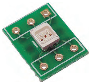
写真1 RGB LED モジュール AE-SDEF0500BC1(秋月電子通商, 10×8 mm) LED素子として SDEF0500BC1(星和電機)を搭載(画像提供: 秋月電子通商)
