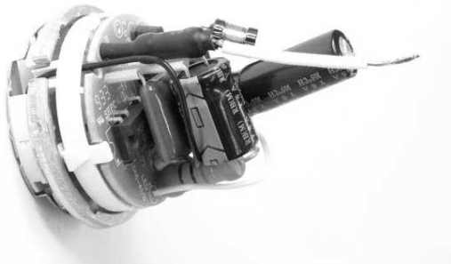
(a) 大きな電解コンデンサが場所を占めている
