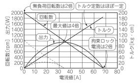
図2-18 電圧を変えた場合の特性変化
