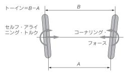
図3-12 トーインとコーナリング・フォースの関係トーインは、ちょうどスキーのボーゲンのようなもの、効果はスキーとよく似ていて、直進性(方向性)が良くなる反面、抵抗が増える、また、キャンバ・スラストでこの抵抗は軽減される。
