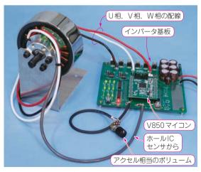
写真 2-1 学習用 CQ ブラシレス・モータ & インバータ・キット の完成状態
