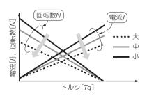
図2-24 巻数を変えた場合の特性変化(トルク基準) 巻数を増やすと低回転・高トルク型に変化する.
