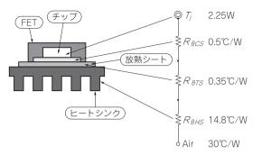
図 4-8 ヒートシンク放熱モデル
