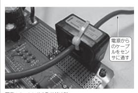
写真4-C センサの取り付け例
