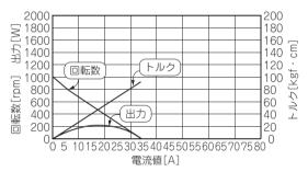
図2-17 ベースとなるモータ特性 この特性のモータをベースに考えていく.
