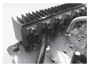
**写真 4-1 ヒートシンクの実装例** ヒートシンクは水谷電機工業製 [PUG16-25] を使用.
