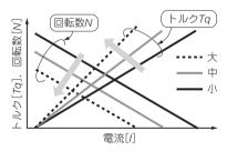
図 2-23 巻数を変えた場合の特性変化 (電流基準) N-1特性は平行移動、トルク定数は巻数に比例するように変化する.
