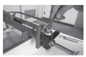
写真3-6 キャスタ角を取って穴加工した前輪取り付け部 キット・カートは、ボール軸受け部の取り付け穴をキャスタ効果のため に上下でずらしている。
