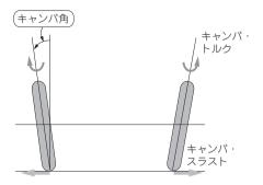
図3-11 キャンバ角とキャンバ・スラストの関係 キャンバ方向に傾きながら直進するタイヤには、傾いている 向きに力が働く。この力のことをキャンバ・スラストとい う
