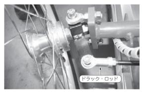
写真3-5 ドラック・ロッドとトーイン調整 左右のドラック・ロッドのピロ・ボールのねじ部の取り付け長さを調整 して、トーの調整をする。トーはほぼ0からマイナスに調整する。
