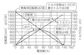
図 2-22 コイル断面積 2 倍で巻数 1/2 の特性
