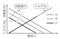
図2-19 電圧を変えたときの特性変化(電流基準) N-1特性は平行移動, Tq-1特性すなわちトルク定数は変わらない.
