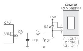
図4-C 電流センサ入力回路
