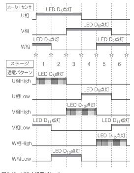
図 5-48 LED と通電パターン 図5-42のタイムチャートにLEDの点灯/消灯のタイミングをかぶせている。
