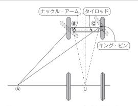
図3-A アッカーマン・ステアリングの幾何学なしくみ
