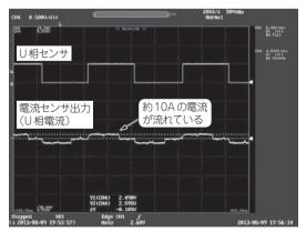
図4-D 電流センサの波形
