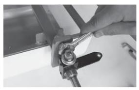
写真3-4 キャンバ角の調整のようす キット・カートでは、ボール軸受けの部分の取り付け長さを調整して、 キャンバ角を自由につけることができる.
