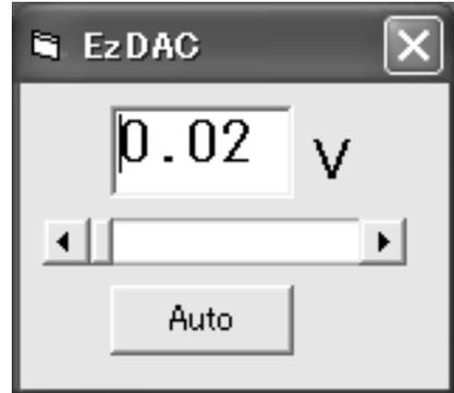
図5 PIOモードでのD-Aコンバータ制御の実行例
