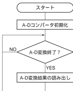
図8 A-Dコンバータのサンプル・プログラムのフロー図
