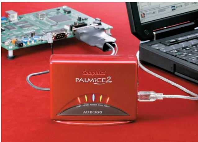
写真3 JTAG デバッガの例(株)コンピューテックス PALMiCE2
