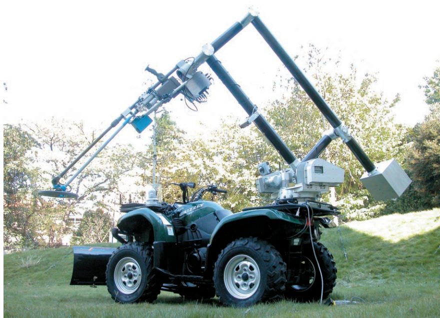
写真5 第3章、第4章の筆者が開発に関わったロボット(バギー車両/遠隔操作ロボット・アーム)
