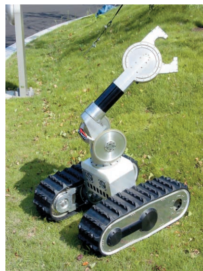
写真6 第3章、第4章の筆者が開発に関わったロボット(クローラ型アーム搭載ロボットの例)
